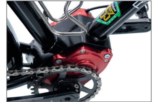
Die eigens angefertigte Edelstahlbrücke hält das Pinion-Getriebe
