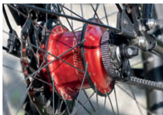
Elektronische Gangwechsel und Riemenantrieb: Rohloffs E-14.
