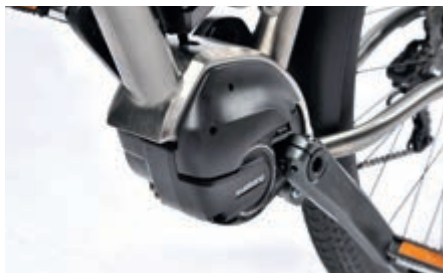
Shimano MTB-Antrieb mit 70 Nm Drehmoment und kompakter Bauweise.
