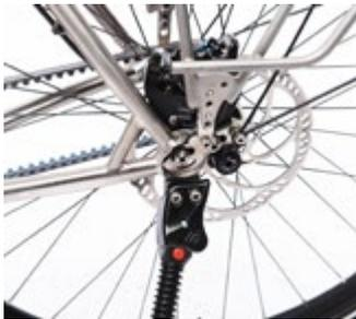
Pinion-Box unter geschmiedeter und gefräster Titan-Brücke.
