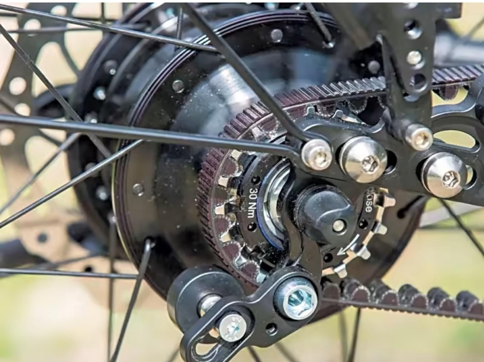
An den kleineren Ritzeln der Rohloff-Nabe verhindert die Snubber-Rolle, dass der Riemen aufläuft und Zähne überspringt. | Bernhard Huber
