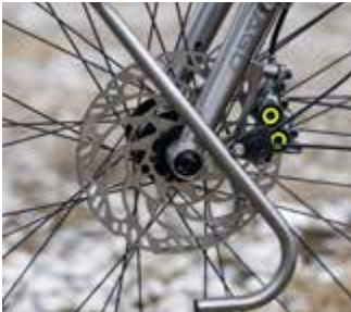
Luxusmaker Eigenbau: selbst das Cockpit ist aus edlem Titan. Unten: Die Magura MT7 glänzt dank 4 Kolben mit solider Verzögerung.
