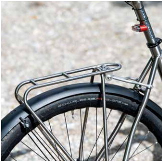
Titan bis ins Detail: auch der Träger ist aus d. ewigen Werkstoff.
