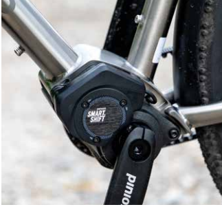
Die Pinion C1.12i mit gleichmäßigen Gangsprüngen von 17,7%.
