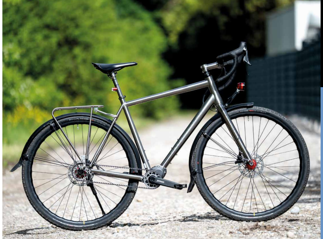
Die Pinion C1.12i mit gleichmäßigen Gangsprüngen von 17,7%.
