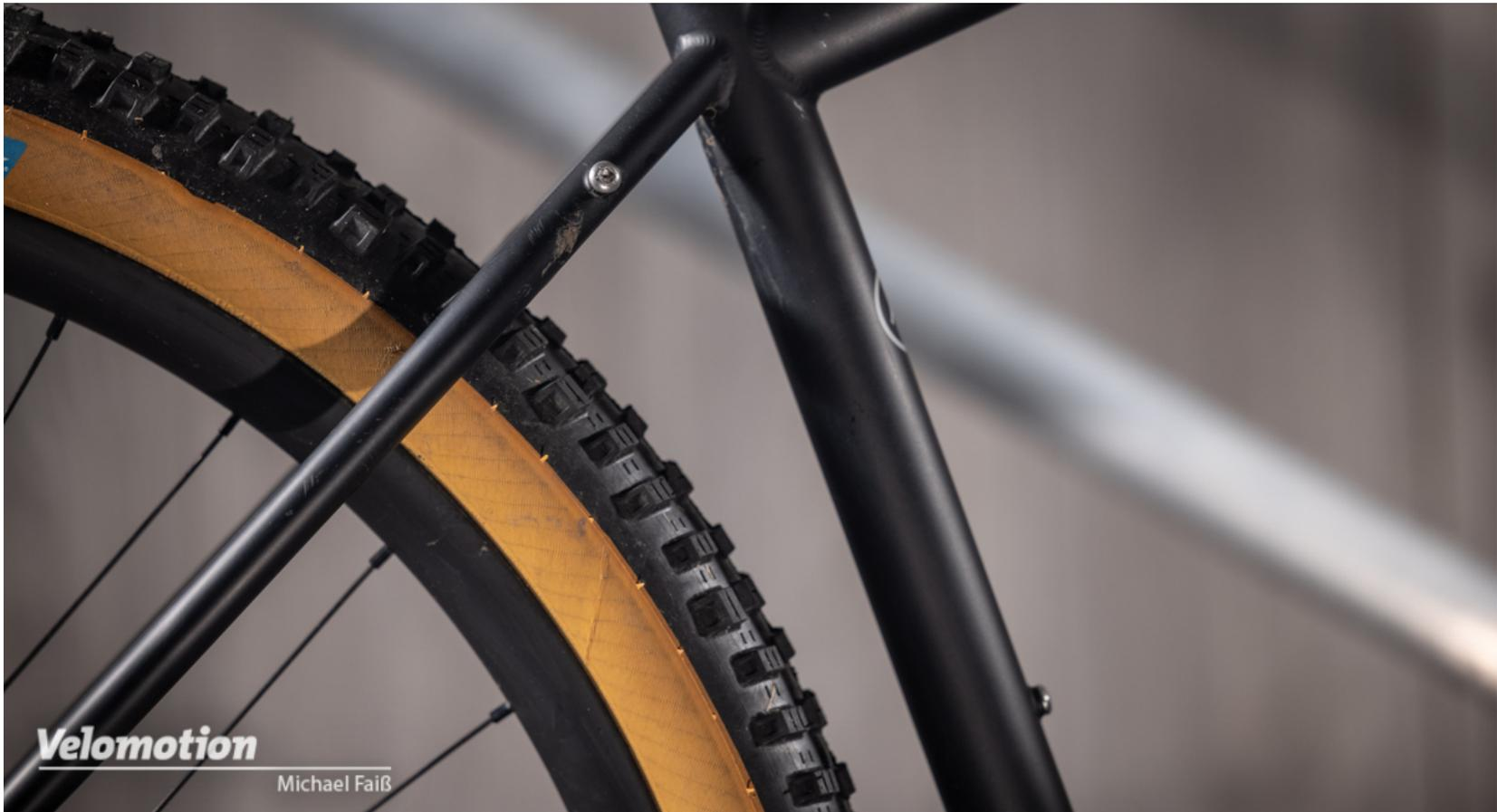
**An den Ösen am Hinterbau lässt sich ein Gepäckträger montieren.**
